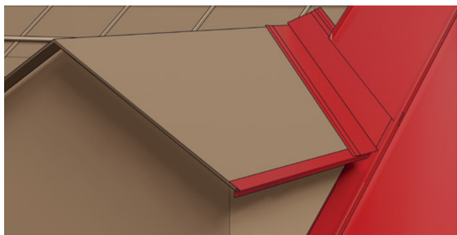
Kuva 33. Asenna seuraavaksi jiirin yläpuoliset pellit.
