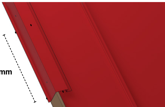
Kuva 45. Päätylistat kiinnitetään päätyräystäslautoihin ja muotoillaan harjalta sopivaksi.
