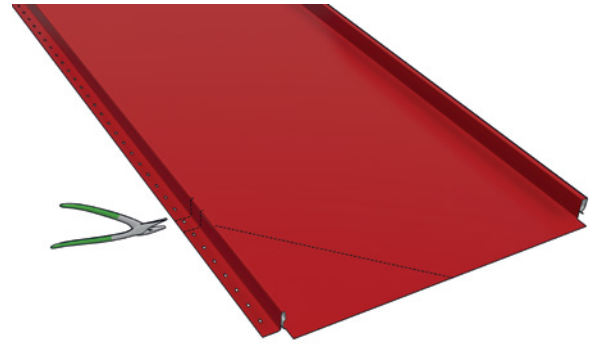
Kuva 14. Käytä apuna myös vasemman puoleisia peltisaksia.
