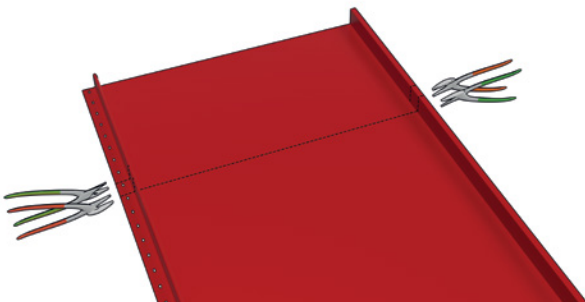
Kuva 22. Käytä molempia eri kätisiä peltisiksi tarpeen mukaan.
