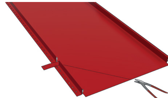
Kuva 16. Taita leikattu sauma alas ja leikkaa levy.
