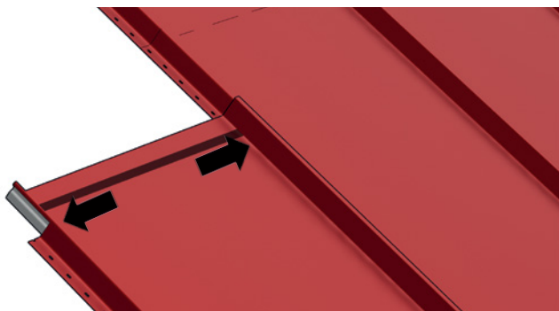
Kuva 38. Käännä saumat ulospäin, jotta limittäiselle levyille saadaan tilaa.
