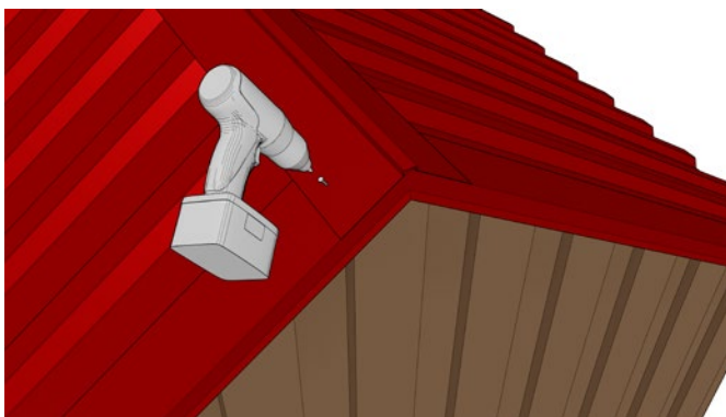
Kuva 9. Harjalista asennetaan viimeisenä.
